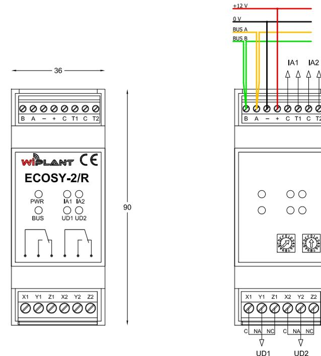
**Attenzione!** Operare sui collegamenti elettrici sempre e solo con modulo disalimentato. Assicurarsi che il voltaggio dell'alimentazione (filo nero "-" e filo rosso "+") sia conforme a quello richiesto dal modulo. I fili giallo e verde devono essere collegati alla comunicazione bus del sistema ECOSY rispettando il collegamento "entra-esce".
