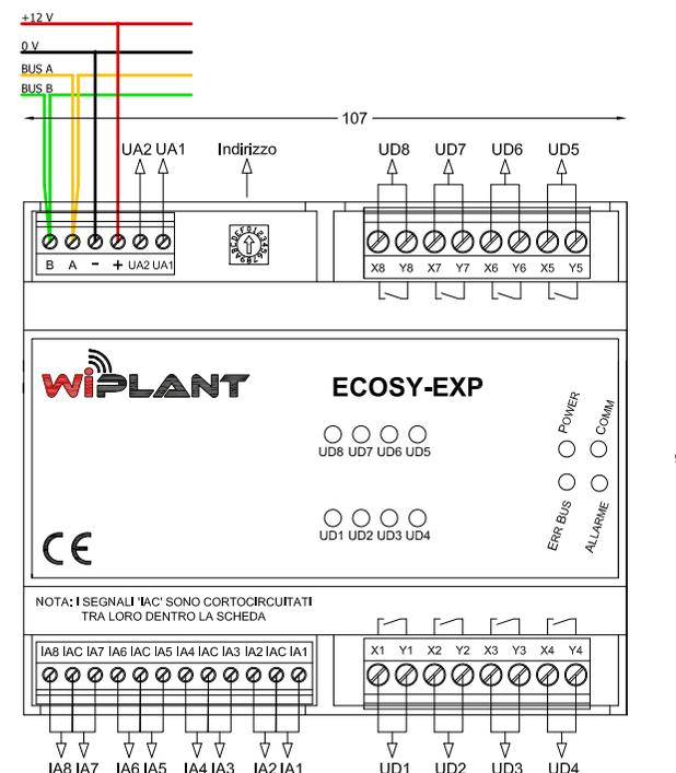
**Attenzione!** Operare sui collegamenti elettrici sempre e solo con modulo disalimentato. Assicurarsi che il voltaggio dell'alimentazione (filo nero "-" e filo rosso "+") sia conforme a quello richiesto dal modulo. I fili giallo e verde devono essere collegati alla comunicazione bus del sistema ECOSY rispettando il collegamento "entra-esce".
