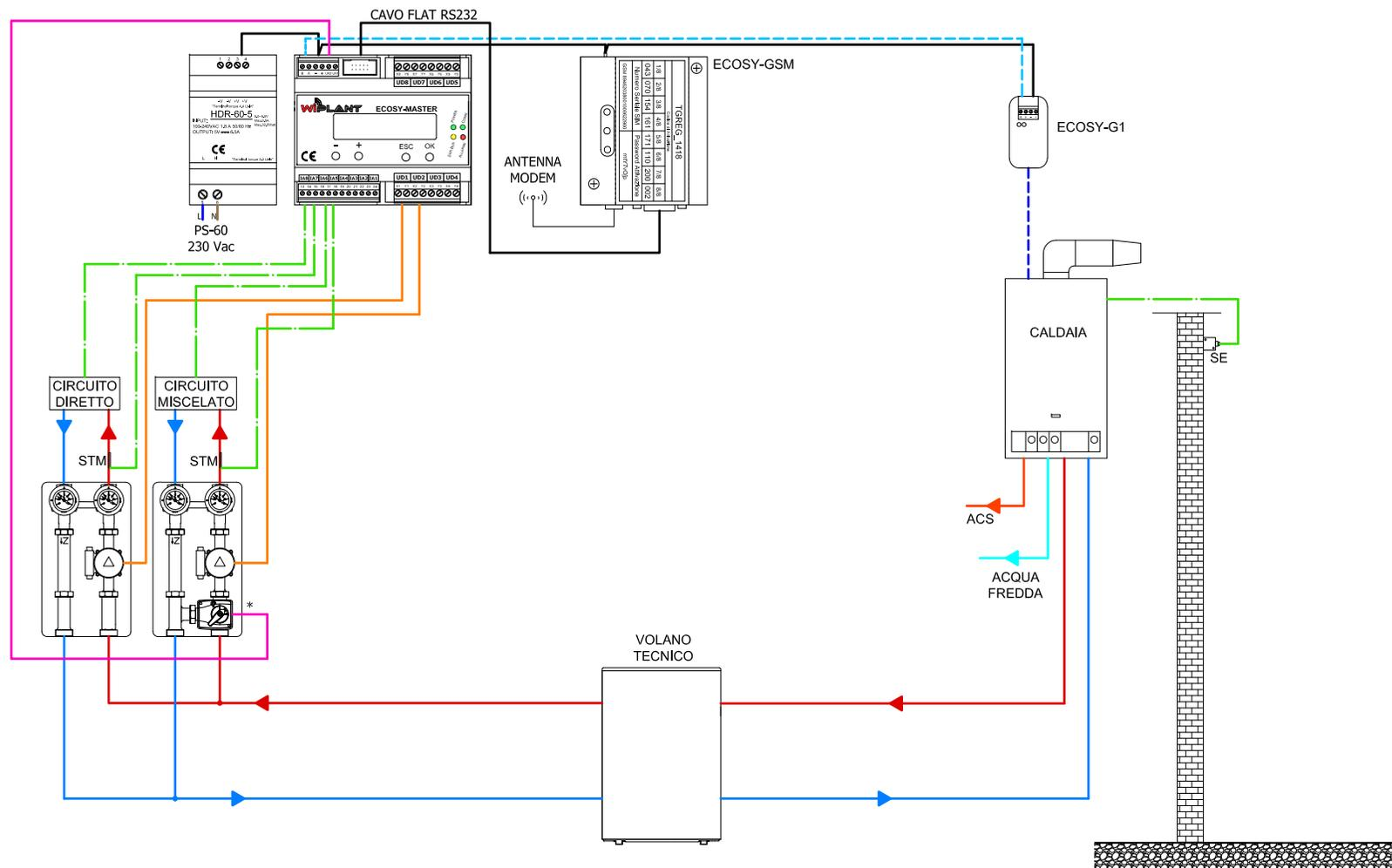
SCHEMA IDRAULICO TERMOREGOLAZIONE \_ ESEMPIO 1: IMPIANTO DI UNA CENTRALE TERMICA CON CALDAIA E 2 CIRCUITI
